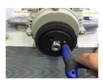
Lösen und entfernen Sie die erste Schraube mit einem Inbus-Schlüssel.
