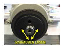
Kleinere Taperbuchsen sind mit zwei Madenschrauben befestigt. Bei größeren Buchsen sind es drei Schrauben.
