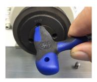
Drehen Sie die Schraube mit dem Schlüssel so weit hinein, bis die Buchse herausgedrückt wird.
