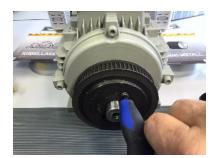
Entfernen Sie auch die zweite Schraube, bei großen Taperbuchsen ebenfalls die dritte Schraube.
